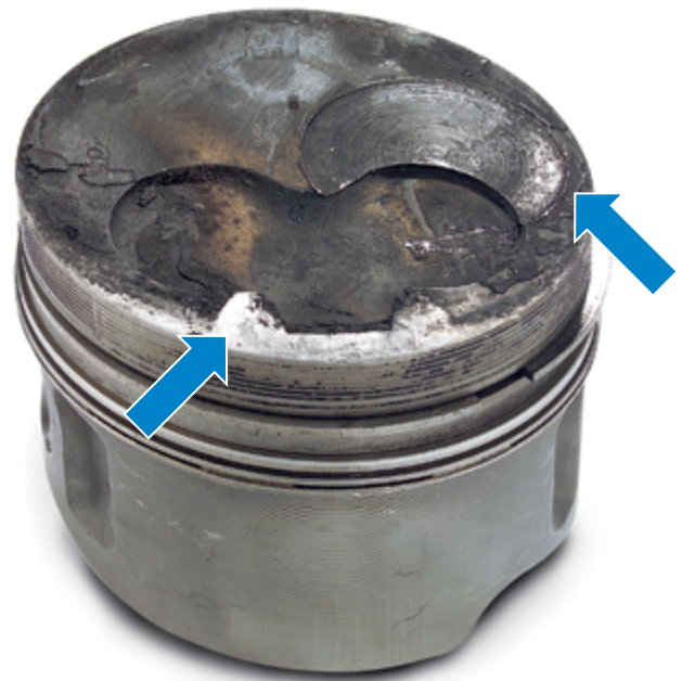
Fig. 4: impacts de choc dus à une surchauffe du moteur
